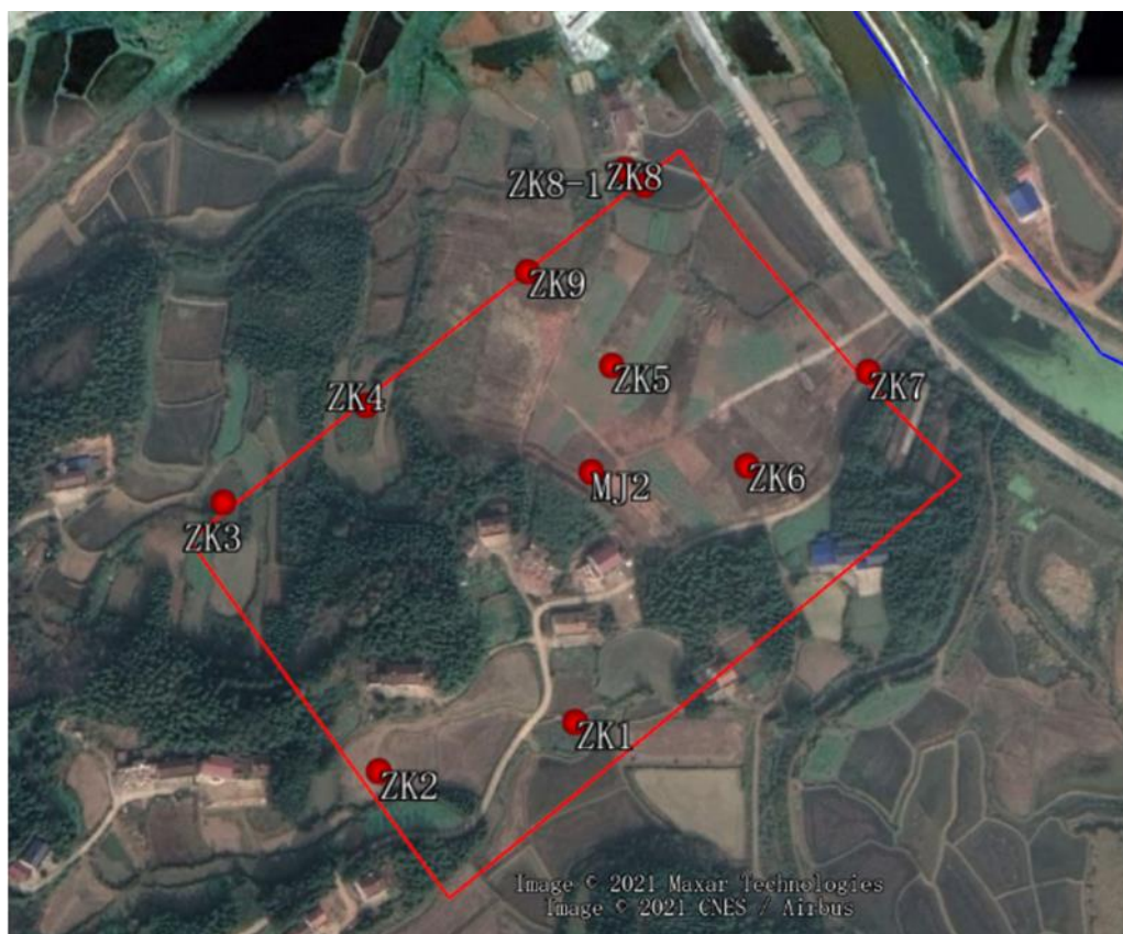
图 7.3-7.钻孔施工布置图
