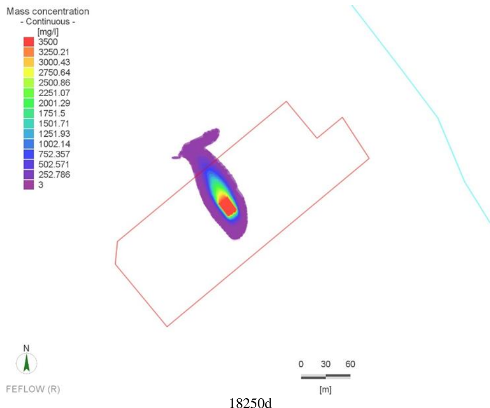
图 8.4-8.非正常状况下污水池 \text{COD}_{\text{Mn}} 超标污染晕示意图
