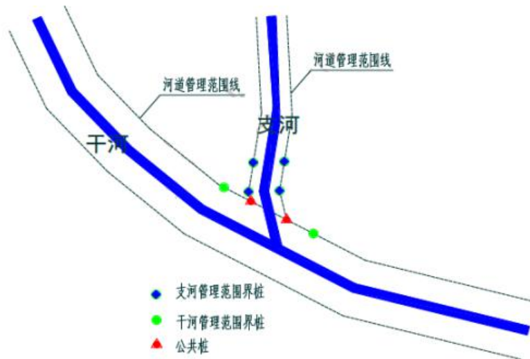
图 4.3.4-1 干支流交汇处无控制性建筑
